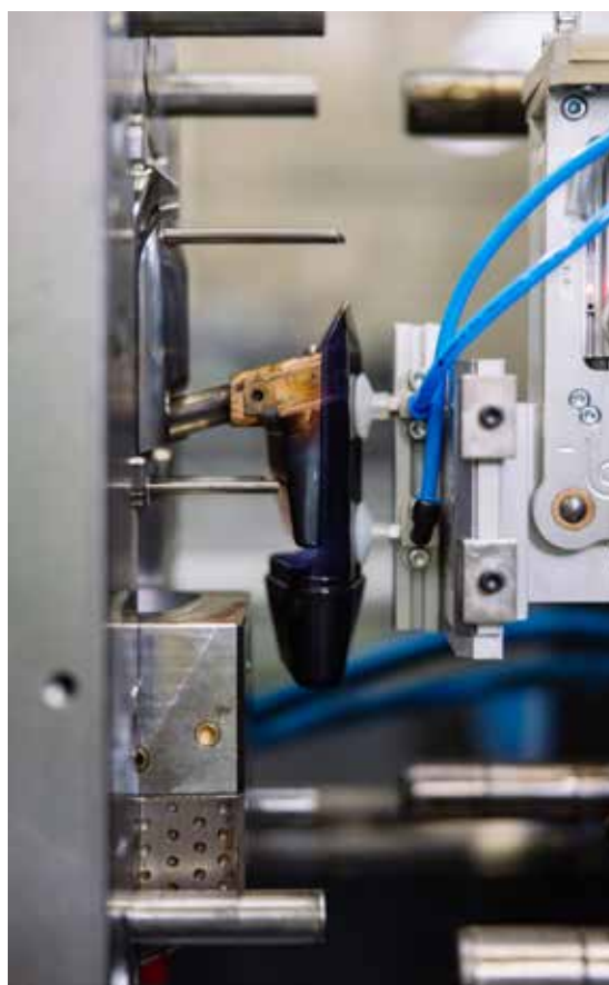
Het spuitgieten van een antikreukneus van gerecyclede schoenzolen bleek nogal een uitdaging. "In het begin kwam er een klonterig product uit. Bleek dat slechts 6 van de 10 korrels in het maalgoed thermoplasten waren."
